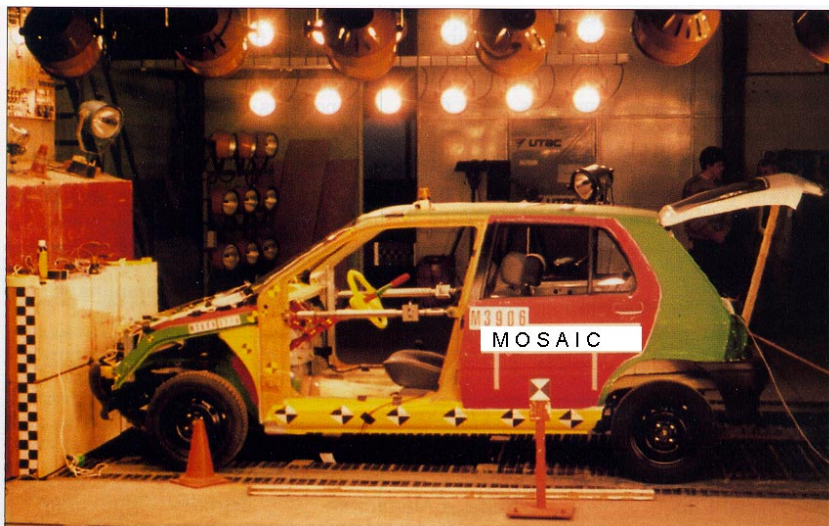
Figure 11 – Crash-test à 50 km/h contre un mur
